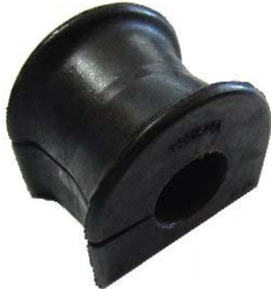
Mesurez le diamètre de la barre stabilisatrice et usinez l'alésage du silentbloc à une cote 0.5 mm inférieur au diamètre de la barre
